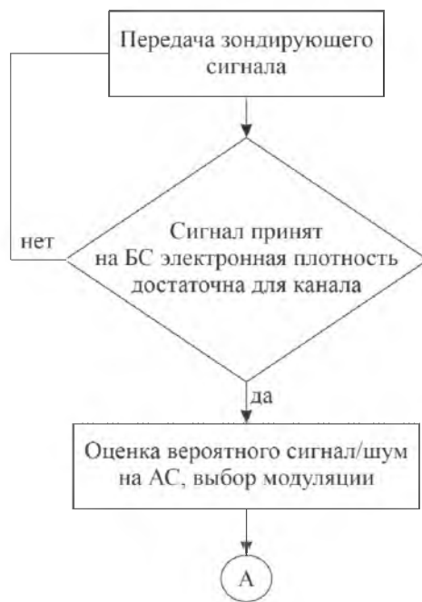
Рис. 2. Блок-схема использования зондирующего сигнала, принимаемого на передающей стороне Fig. 2. Block diagram of using the probing signal received at the transmitting side
