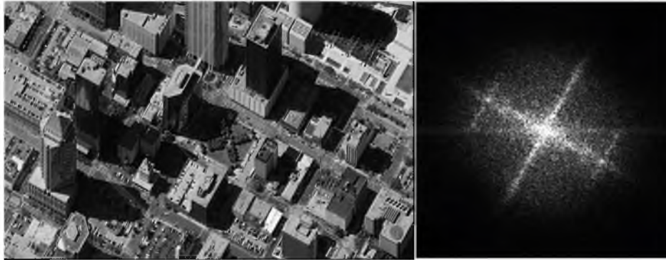
Рис. 6. Фрагмент сформированного со сверхразрешением изображения «QuickBird_tampa_dwntn_psh_8mar2002» с продолжением спектра до значения рекурсии L=40 Fig. 6. A fragment of the image "QuickBird_tampa_dwntn_psh_8mar2002" generated with superresolution, with continuation of the spectrum to the value of recursion L=40
