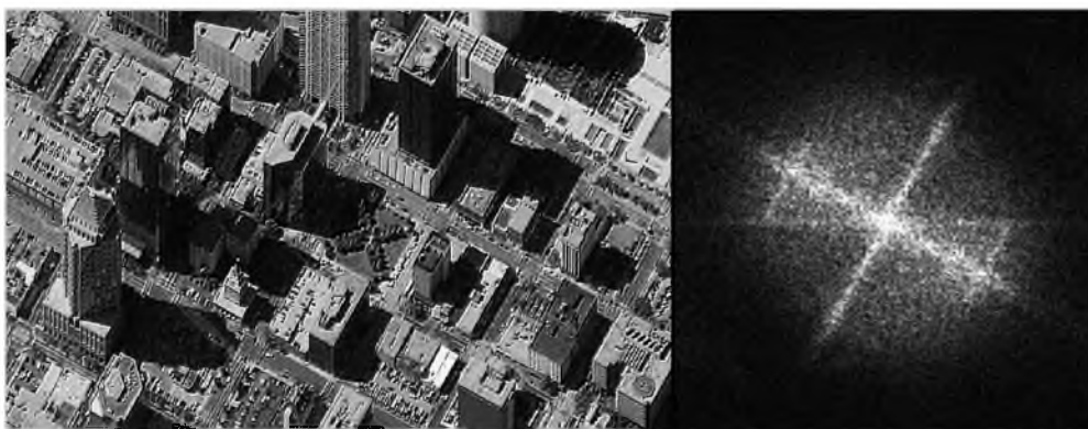
Рис. 7. Фрагмент сформированного со сверхразрешением изображения «QuickBird_tampa_dwntn_psh_8mar2002» с продолжением спектра до значения рекурсии L=45-50
