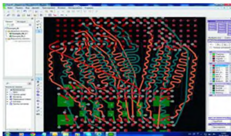
Рис. 1. Структура печатной платы с меандровыми линиями задержки Fig. 1. The structure of the printed circuit board to meander delay lines
