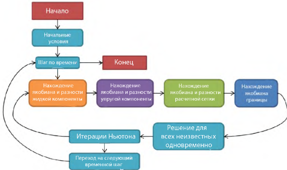
Рис. 8. Блок-схема жидкостно-структурного взаимодействия с моноклитной связью упругой и жидкой компонент Fig. 8. Block diagram of the liquid-structural interaction with the monolithic relation of the elastic and liquid components
