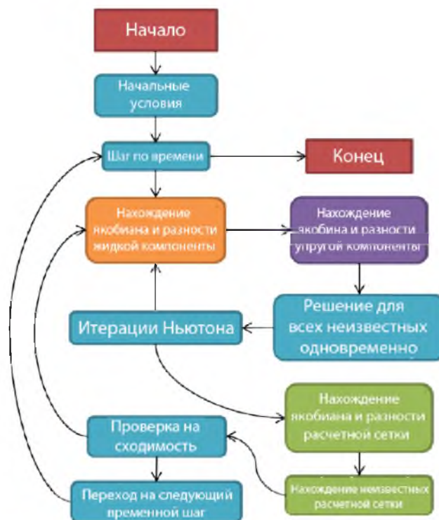
Рис. 7. Блок-схема жидкостно-структурного взаимодействия с частичной связью упругой и жидкой компонент Fig. 7. Block diagram of the liquid-structural interaction with the partial coupling of the elastic and liquid components
