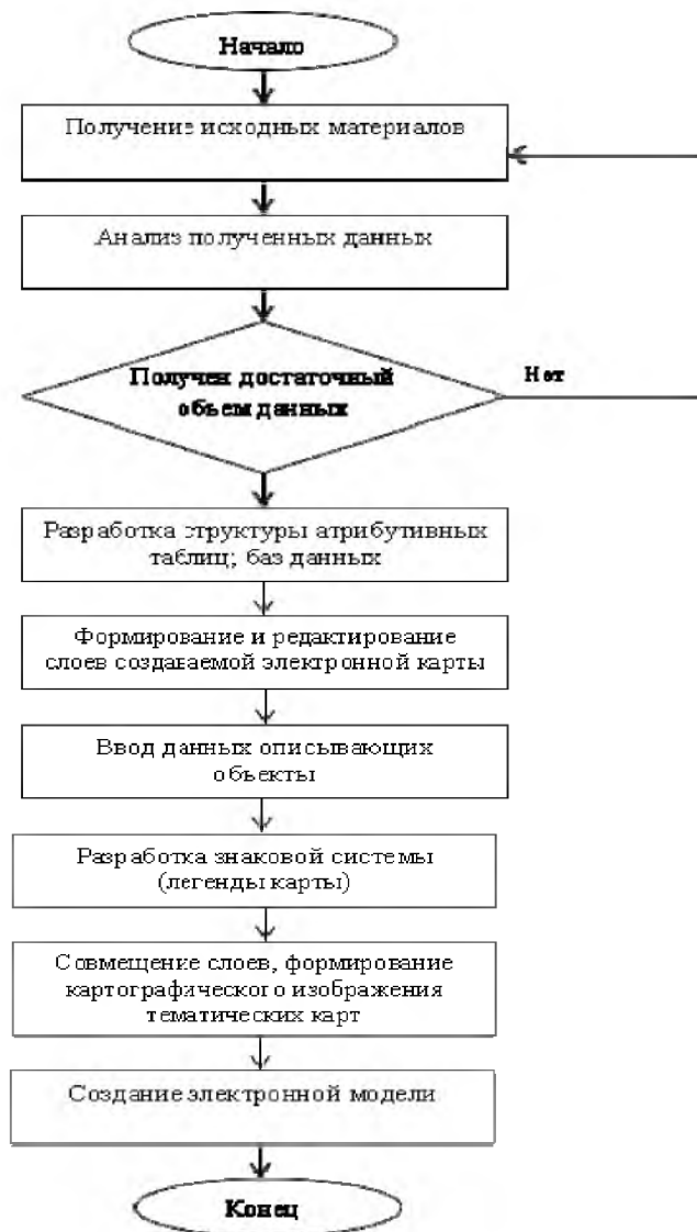
Рис. 1. Алгоритм создания электронной модели схемы обращения с отходами Fig. 1. Algorithm for the creation of electronic model of waste management scheme
