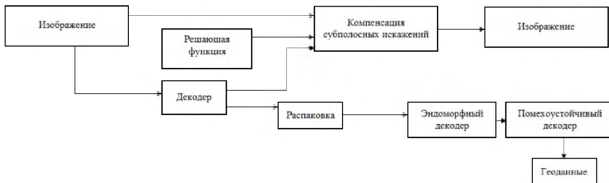
Рис. 2. Схема декодирования информации Fig. 2. The scheme of decoding information
