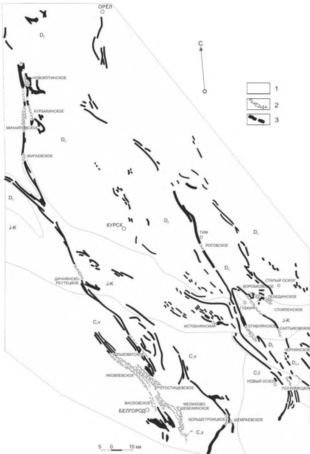
Рис. 1. Схема распространения железорудных кор выветривания в пределах бассейна Курской магнитной аномалии: 1 – осадочный чехол (глины (J-K); известняки и доломиты (C 1v ); глинистые известняки (C 1t ); глины и аргиллиты карбонатизированные (D 2 )); 2 – залежи богатых железных руд; 3 – железистые кварциты и сланцы
