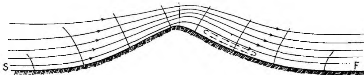
Рис. 1. Преодоление звуком «горы» в направлении с наветренной стороны к подветренной [Humphreys, 1921]
