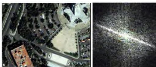
Рис.2. Фрагмент ЦКИ со спутника QuickBird с повышением резкости усилением контраста и его ПЧС
