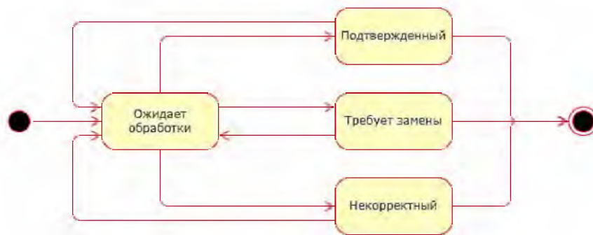
Рис. 1. UML-диаграмма состояний для обрабатываемых в процессе очистки данных навыков Fig. 1. UML state diagram of the skills processing in the data cleansing process
