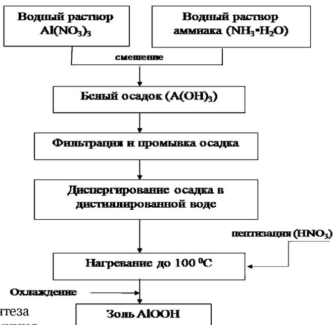
Рис. 3. Блок-схема синтеза золя гидроксида алюминия из нитрата алюминия
