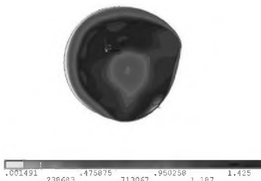
Рис. 4. Распределение величины истинной деформации в поперечном сечении заготовки.
