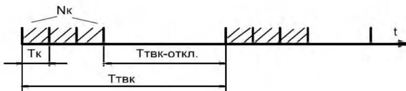
Рис. 1. Определение скважности действующей ТВК
