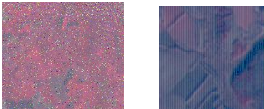
Рис.1. Помехи на космических снимках вида импульсный шум (слева) и полосы(справа)
