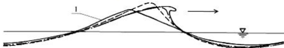
Рис. 1. Профили ветровых волн с различной степенью укрупненности гребней; 1 – симметричная волна Стокса
