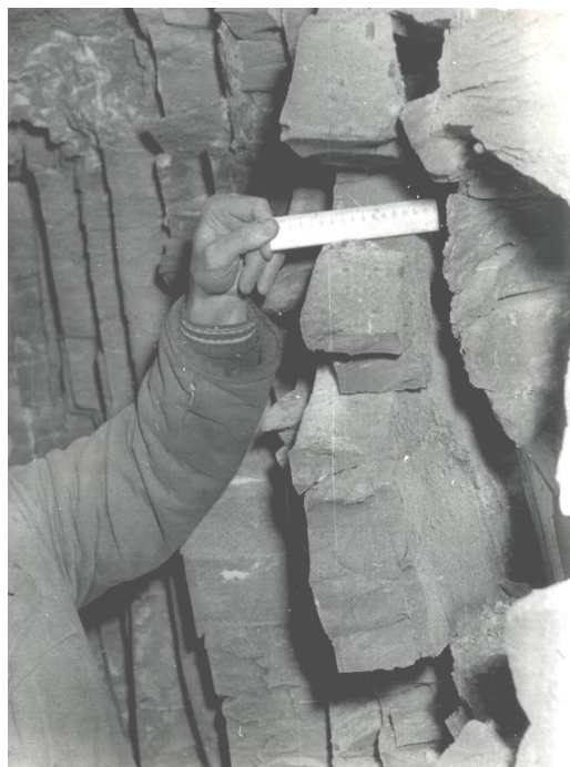
Рис. 3. Характер разделения замороженных глин кимеридж-оксфорда на структурные блоки при их вскрытии (ствол №1, глубина 371 м)
