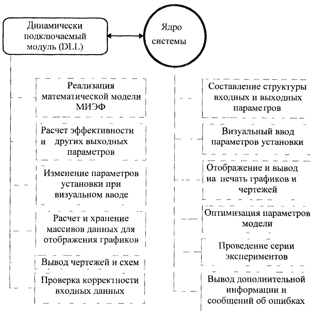
Рис. 1. Общая структура программного комплекса для параметрического проектирования
