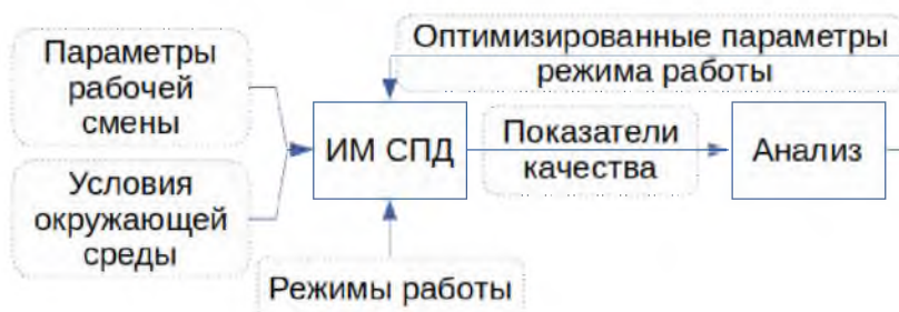
Рис. 3. Оптимизация режимов работы СПД с помощью имитационной модели (ИМ) Fig. 3. Optimization of data network operation modes using a simulation model
