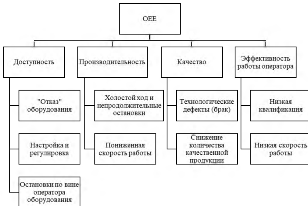
Рис. 3. Факторы управления показателем OEE Fig. 3. Factors driving the OEE score
