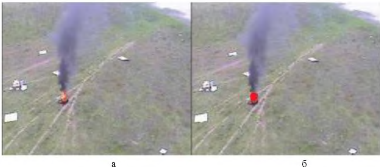
Рис. 1. Сегментация источника огня: а – исходное изображение; б – сегментированное изображение (пиксели пожара выделены красным)
