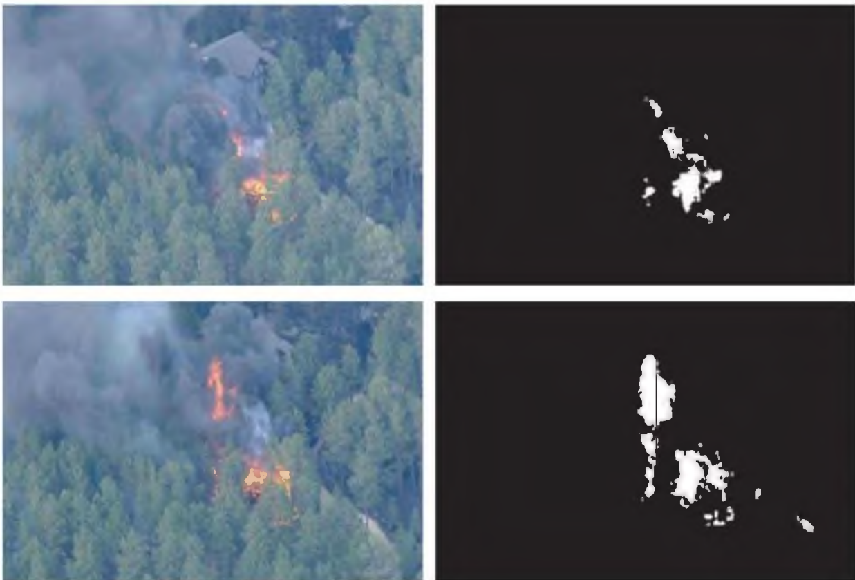
Рис. 8. Иллюстрация применения правила сегментации пикселей, относящихся к изображению огня (слева – исходные изображения, справа – результат сегментации)
