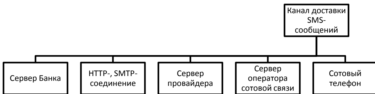
Рис.1. 3. Схема соединения сервера банка с сервером провайдера в целях осуществления мобильного банкинга
