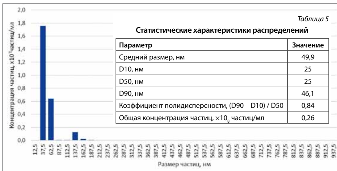
Рис. 4. Распределение частиц по размерам в образце нанокapsул сульфата кобальта в желатиновой камеди (соотношение «ядро : оболочка» 1:3)
