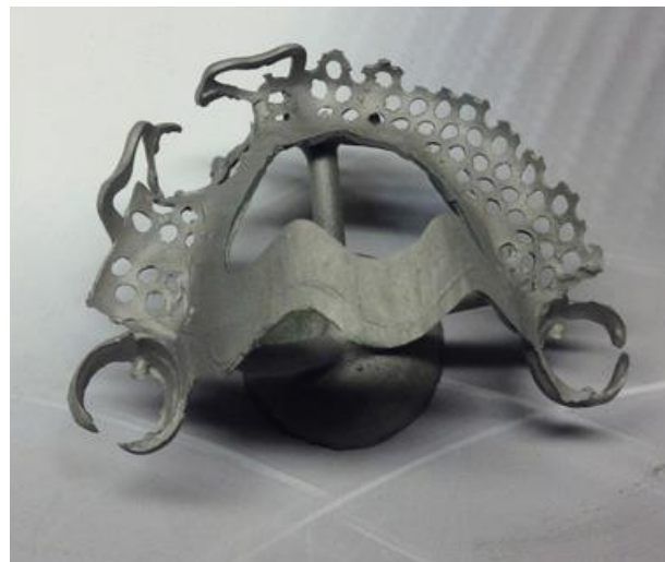
Рис.24. Обработка отлитого каркаса
