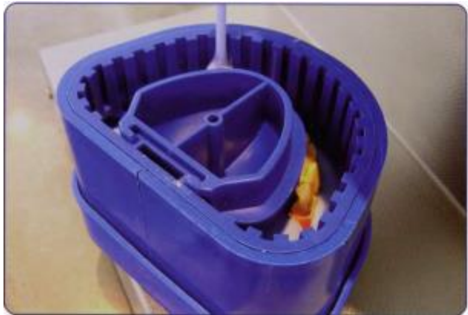
Рис.21. Заливка мастер модели силиконом для дублирования
