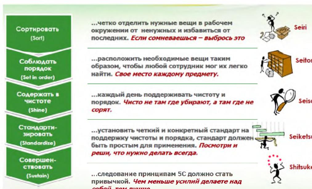
Рисунок. Система «5S» как инструмент организации рабочего пространства
