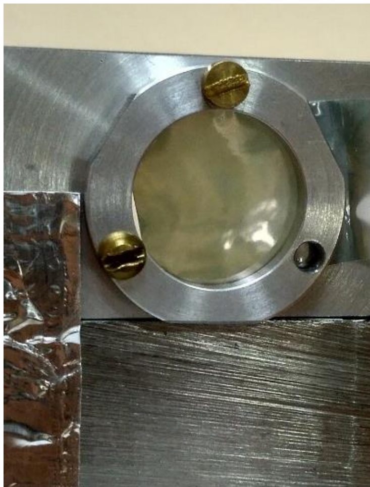
Рисунок 10. Образец ПЭТ, закрепленный в держателе
