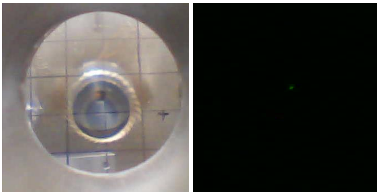
Рисунок 11. Фотография сетки для масштабирования дальнейших снимков (слева) и фотография следа пучка электронов на экране (справа). Величина тока 8 нА.
