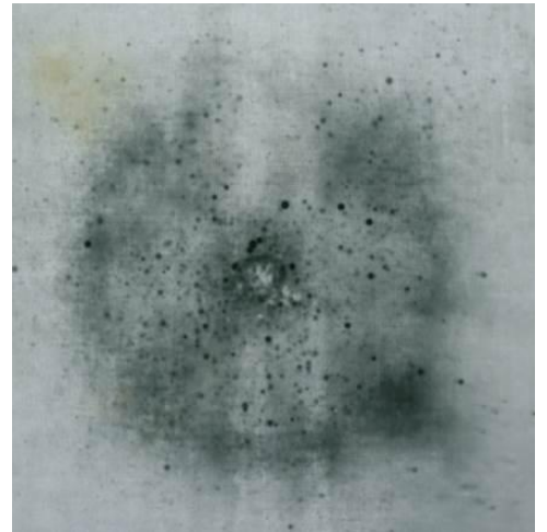
Рис. 2.12. Изображение контактограммы следов близкого выстрела (пистолет Макарова, дистанция 5 см, определяемый металл — медь), полученное с мишени из ткани
