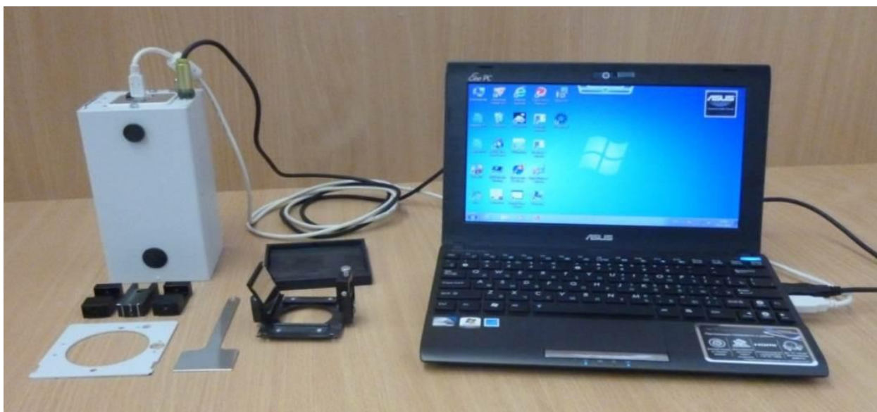
Рис. 2.8. Внешний вид портативного анализатора цвета: 1 — измерительный блок; 2 — кабель USB; 3 — кабель питания внутреннего осветителя; 4 — компьютер; 5 — ярлык программы, управляющей цветом; 6 — кювета для исследуемого образца; 7 — лопатка; 8 — сменные стойки; 9 — сменная верхняя крышка защитного корпуса; 10 — кронштейн световода внешнего осветителя
