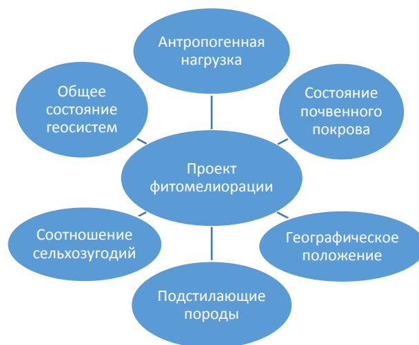
Рис. 1. Факторы, учитываемые при планировании фитомелиоративных работ Fig. 1. Factors to consider when planning phyto-reclamation works
