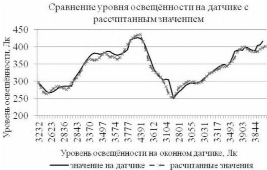
Рисунок 3.16 – Сравнение реального уровня освещенности на датчике с рассчитанным значением
