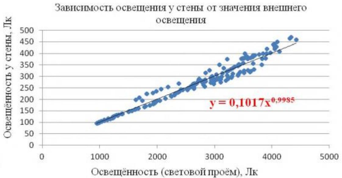
Рисунок 3.13 – Зависимость внутреннего освещения от значения внешнего свечения
