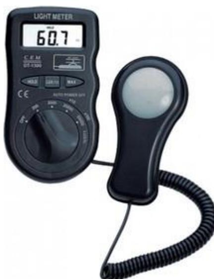
Рисунок 2.12 – Цифровой люксметр DT-1301
