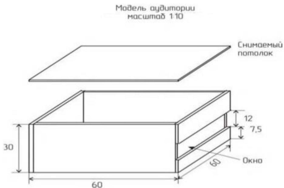
Рисунок 2.6 – Схематичный чертеж модели аудитории
