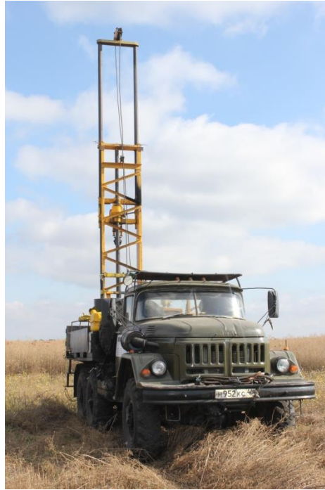
Рисунок 3.1 – Буровая установка ПБУ-2-114
