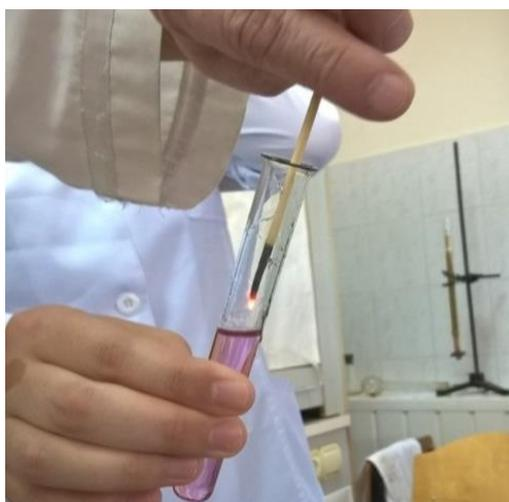
Рис. 2.17. Проверка наличия кислорода
