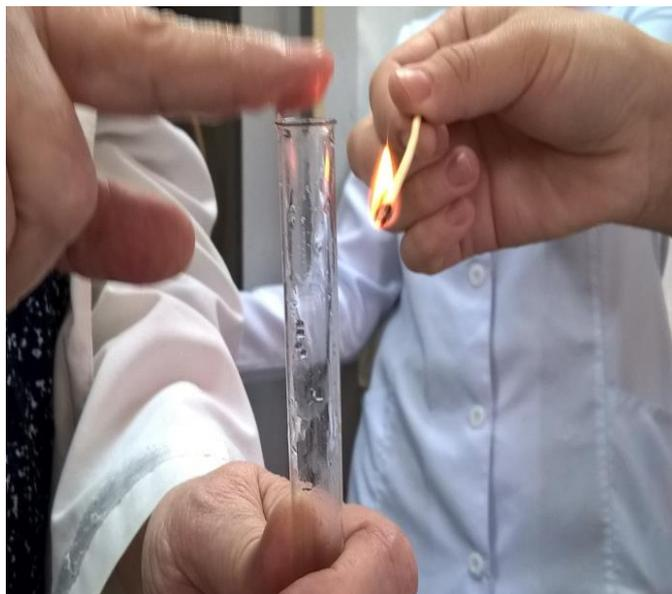
Рис. 2.16. Проверка наличия водорода
