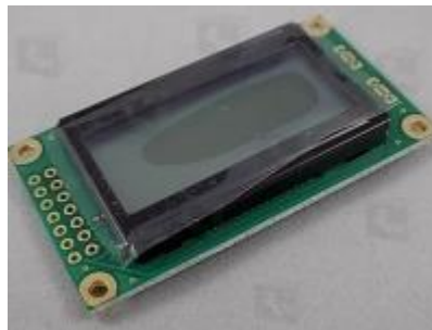
Рисунок 7 – ЖК экран LCDWH0802
