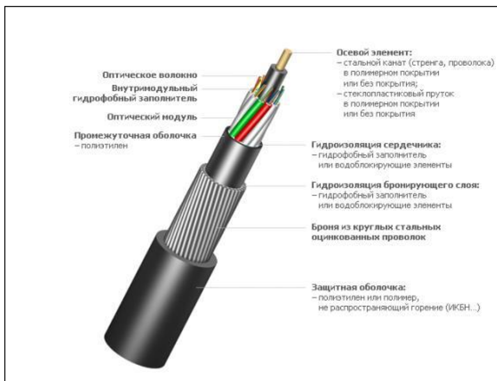
Рисунок 3.5 – Элементы волоконно-оптического кабеля марки ИКБ
