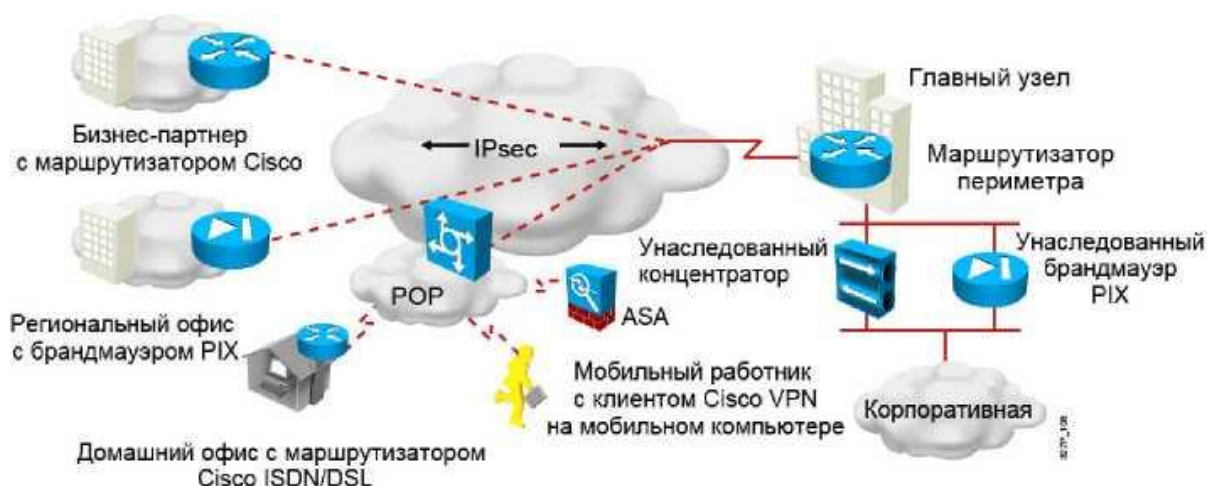
Рисунок 2.2 – Концептуальная схема VPN сети
