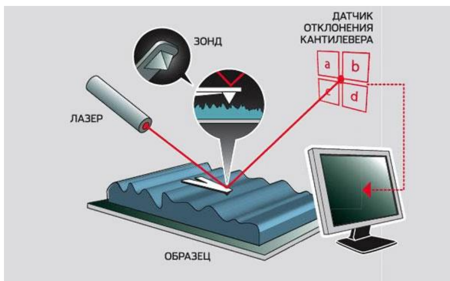
Рис. 11. Принцип работы АСМ
