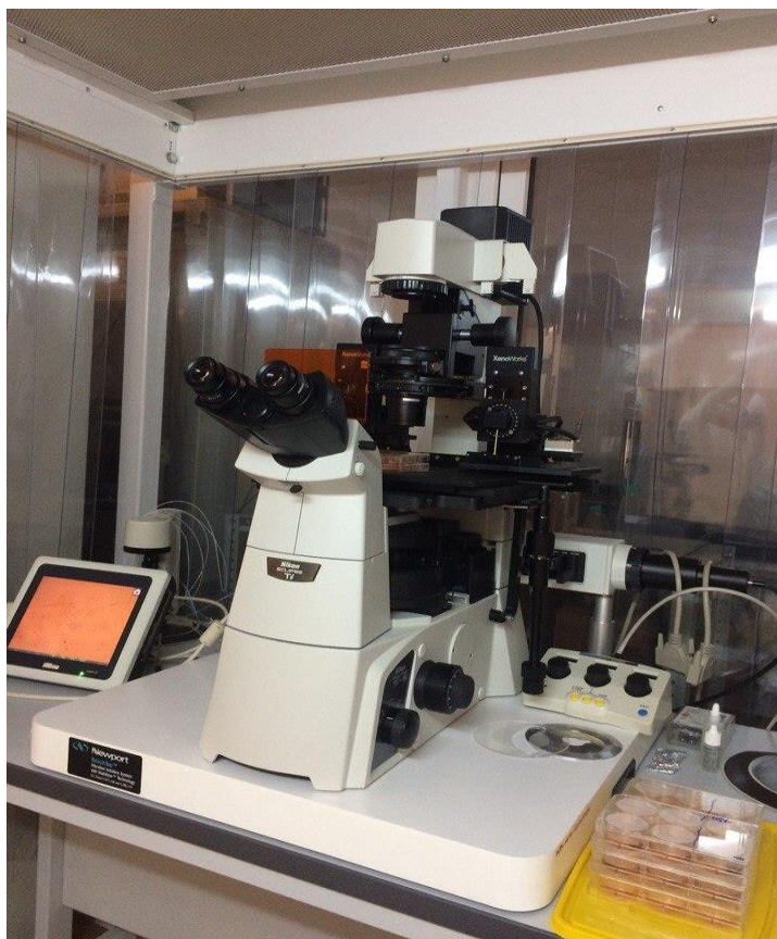
Рис. 9. Флуоресцентный микроскоп (Eclipse Ti- U, фирмы Nikon, Япония)
