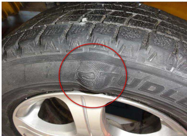
Рис. 1.1. Изображение вздутия (кила) на автомобильной шине
