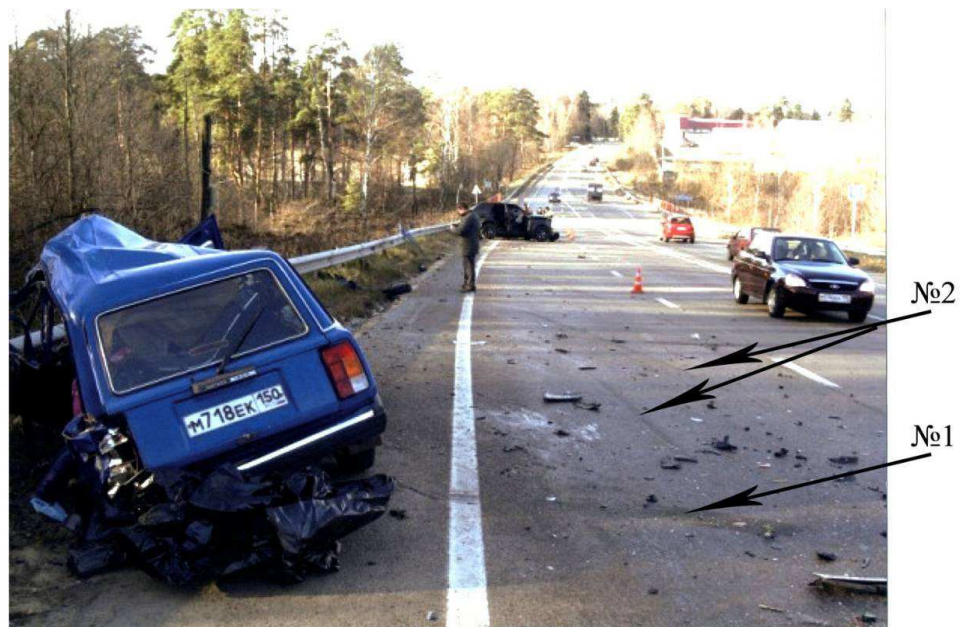
Иллюстрация № 2 Место столкновения транспортных средств (стрелками указано расположение и наличие следов места столкновения) № 1 - отклонение следа торможения заднего колеса автомобиля ВАЗ 2104; № 2 - начало следов юза автомобиля Гран Витара; № 3 - отклонение следа юза передних колес автомобиля ВАЗ 2104
