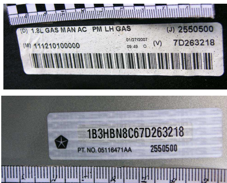
Рис. 2.2. Маркировочные обозначения, обнаруженные на декоративной решётке радиатора и внутренней полости заднего бампера автомобиля «Додж Калибер»
