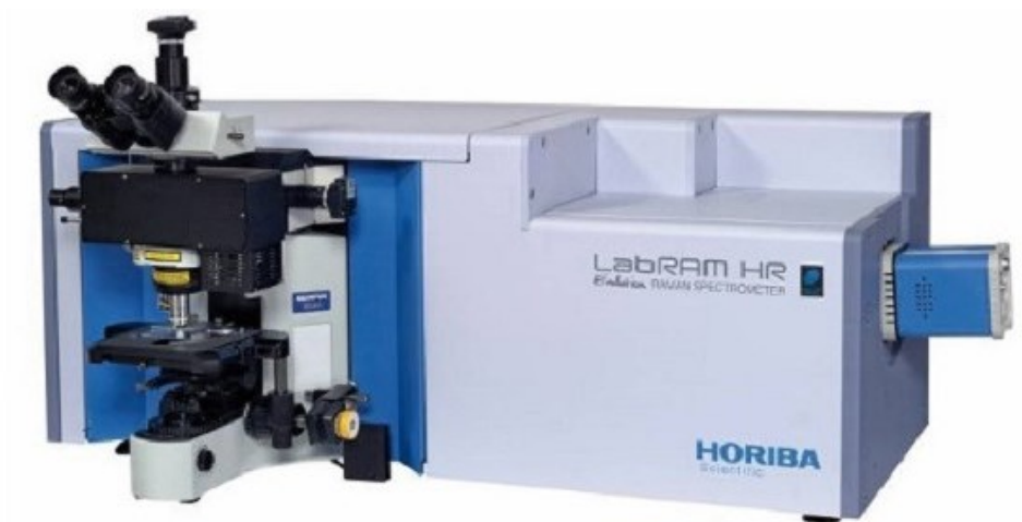
Рис. 2.11. Спектрометр комбинационного рассеяния (рамановский) LabRAM HR Evolution [79]
