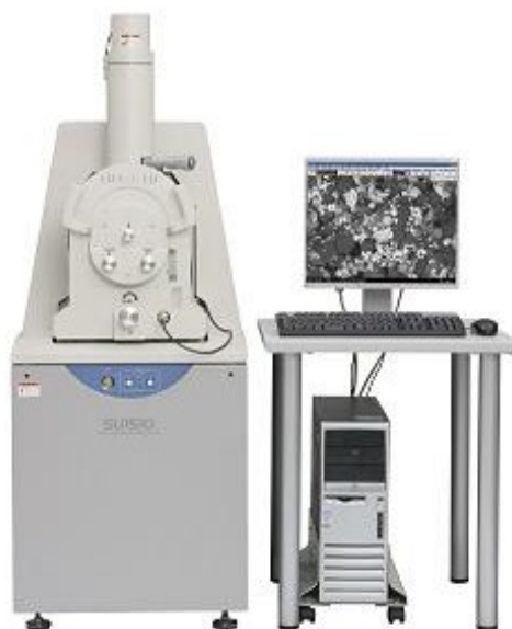
Рис. 2.14. Растровый электронный микроскоп HitachiSU1510[84]
