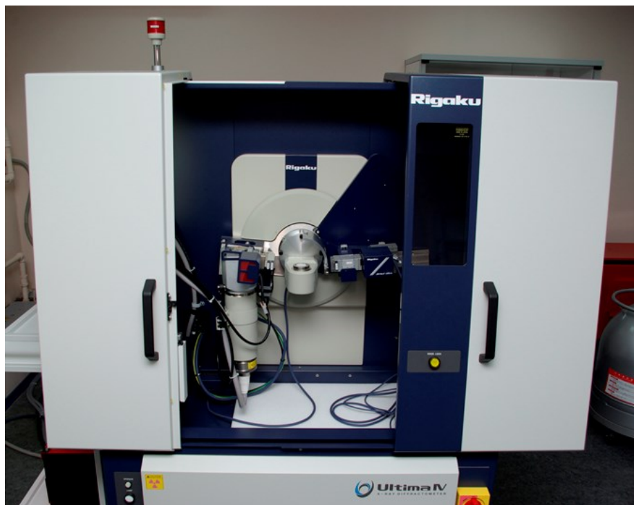
Рис. 2.9. Многоцелевой рентгеновский дифрактометр Rigaku Ultima IV [76]
