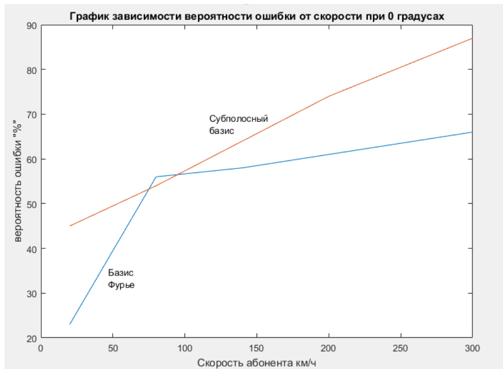
Рисунок 50 - График зависимости вероятности ошибки от скорости абонента при угле движения абонента 0^\circ
