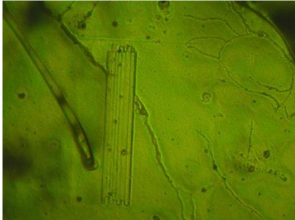
Рис. 2.5 Микрофотография кремниевой подложки с жидким кристаллом при скрещенных поляризаторах
