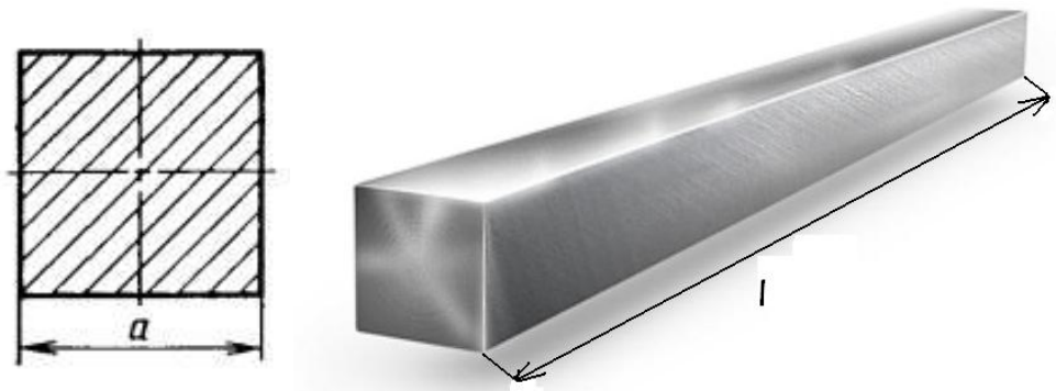
Рисунок А.2 – Стальной прокат квадратного сечения
