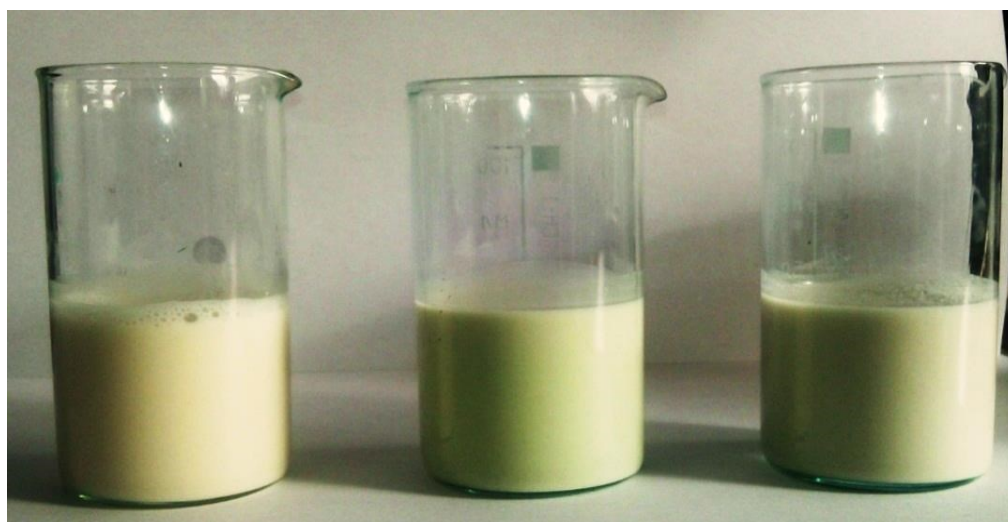
Рис.3.3. Образцы, полученные из арахиса, семечек тыквы и подсолнечника с использованием для перемешивания эмульгатора SULVERSON L5M
