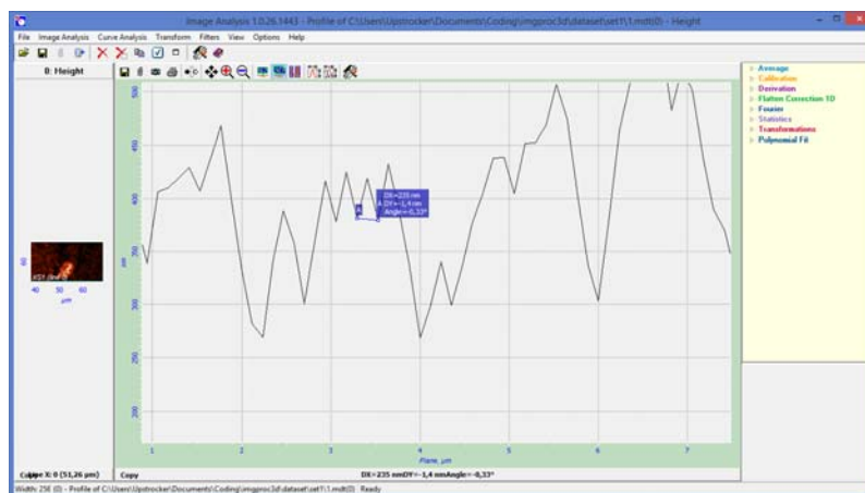
Рис. 3.15. Расстояние между точками основания экстремума ( DX ), между экстремумом и основанием ( DY ), угол между точками основания (Angle)
