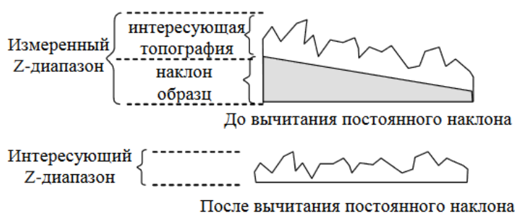
Рис. 2.3. Устранение постоянного наклона из СЗМ-изображения
