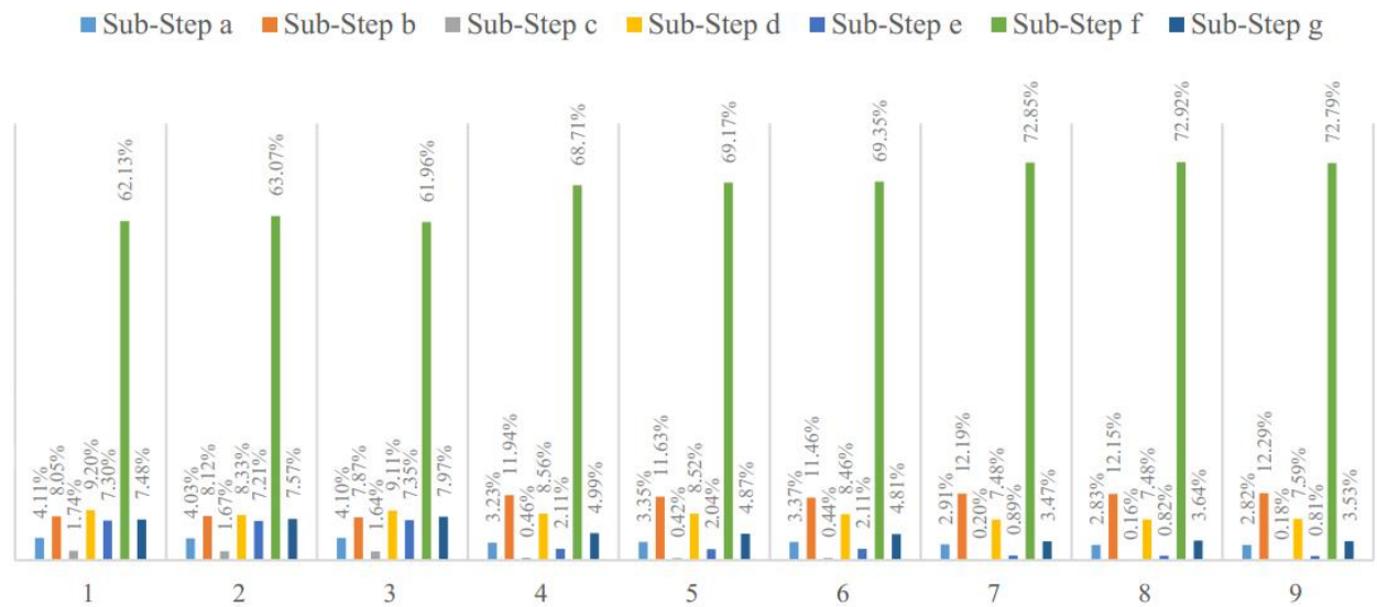
Рисунок 3.7. Потребление времени каждым подэтапом в универсальной функции кригинга .
