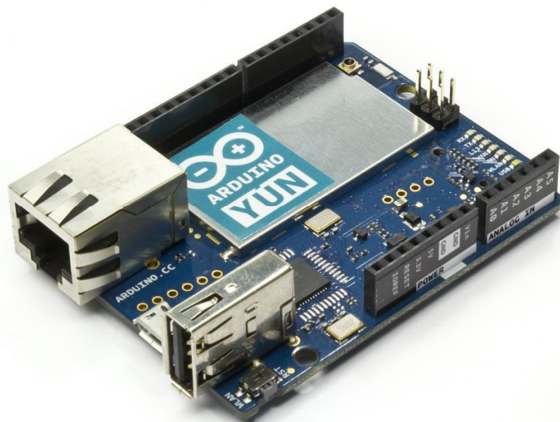
Рисунок 3 – Внешний вид платы Arduino Yun
