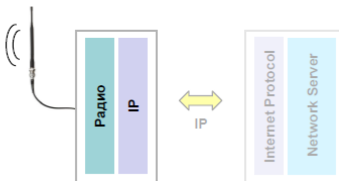
Рисунок 21 – Схема работы шлюза LoRaWAN
