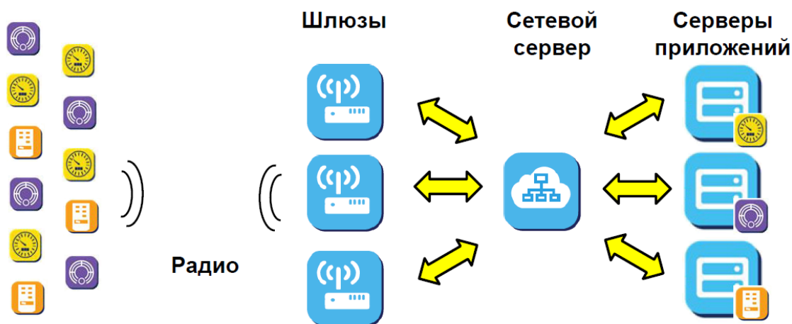
Рисунок 16 – Схема взаимодействия элементов сети с использованием протокола LoRaWAN
