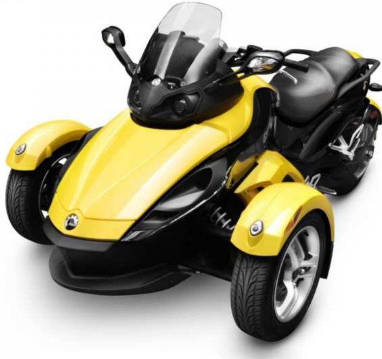
Рис. 2.5. Мототранспортные средства категории L 5 : американский BRP Can-Am Spyder Roadster, оснащенный двигателем объемом 998 см 3 .
