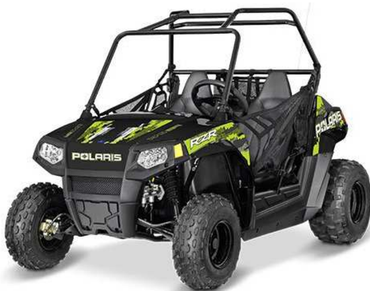
Рис. 7. Мототранспортные средства категории L 7 : американский UTV Polaris RZR 170, оснащенный двигателем мощностью 5 кВт.
