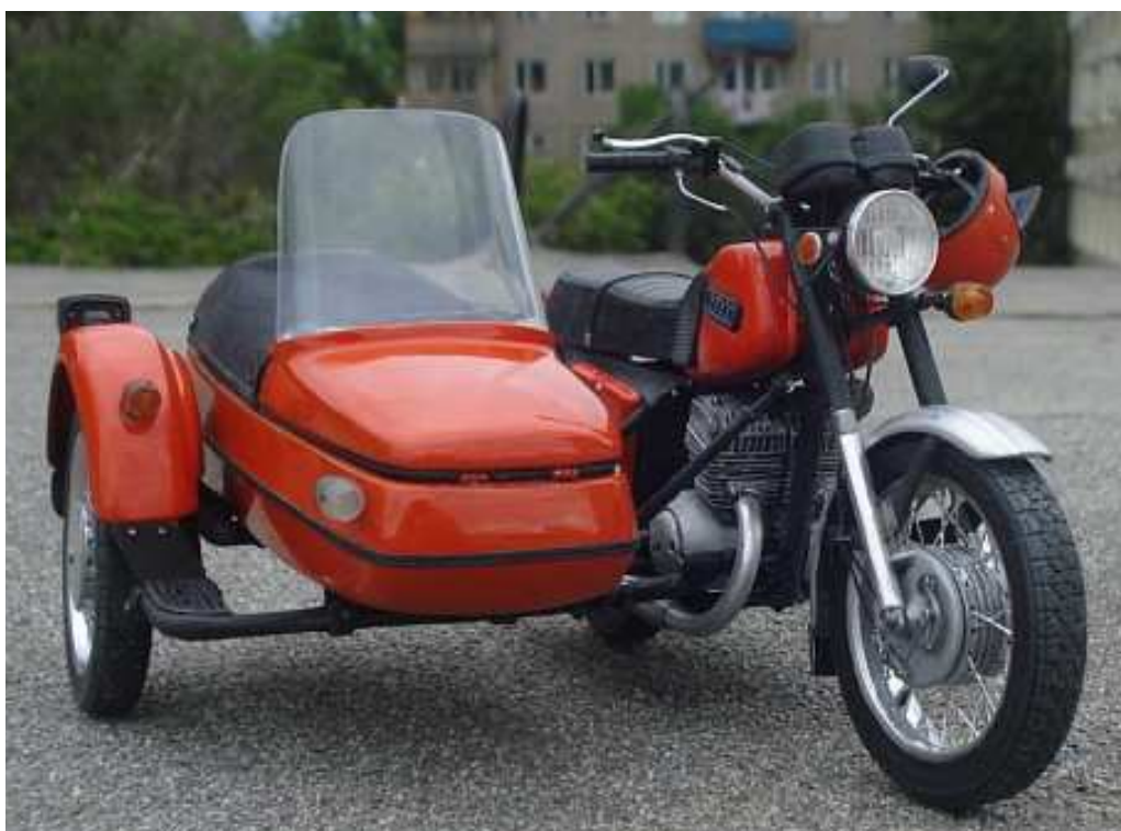
Рис. 2.4. Мототранспортные средства категории L_4 : советский мотоцикл ИЖ «Юпитер 5», оснащенный двигателем объемом 347,6 см 3 .
