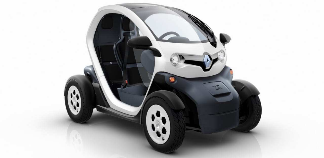
Рис. 2.6. Мототранспортные средства категории L 6 : французский Renault Twizy Urban 45, оснащенный двигателем мощностью 4 кВт.
