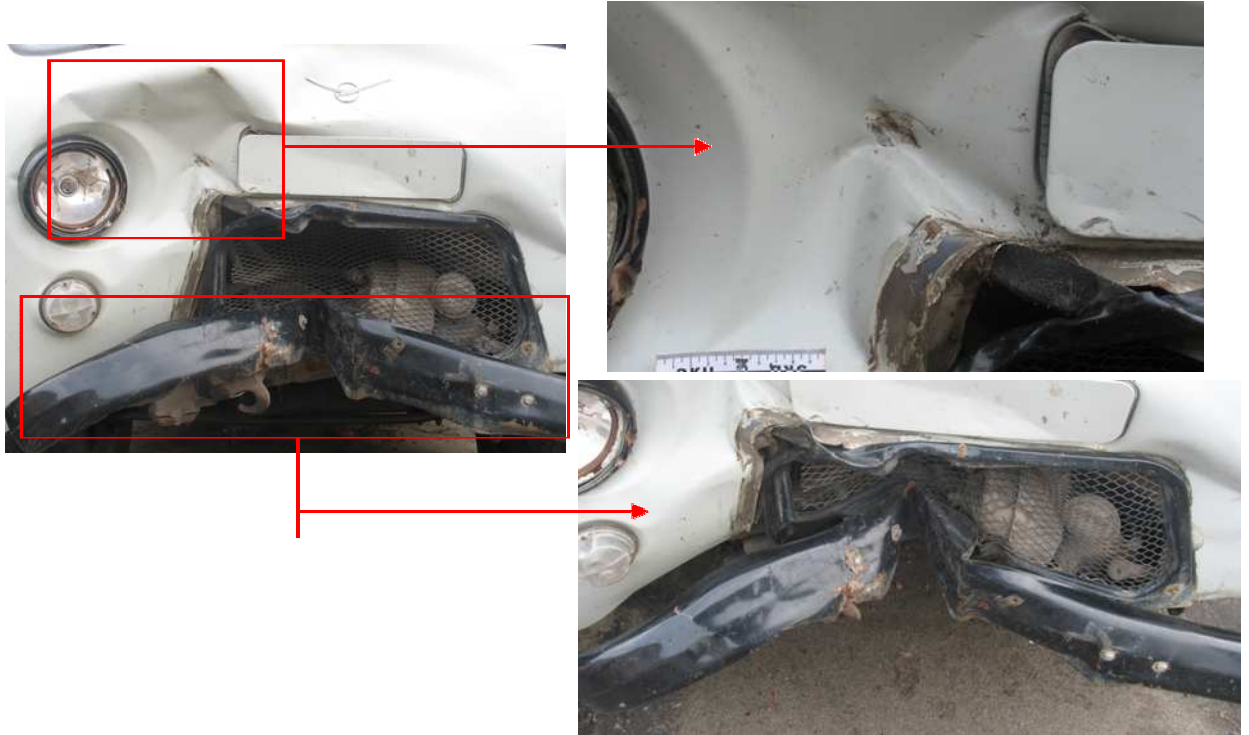
Фото 6-8. Повреждения передней части кузова автомобиля УАЗ-22069204, представленного на исследование.
