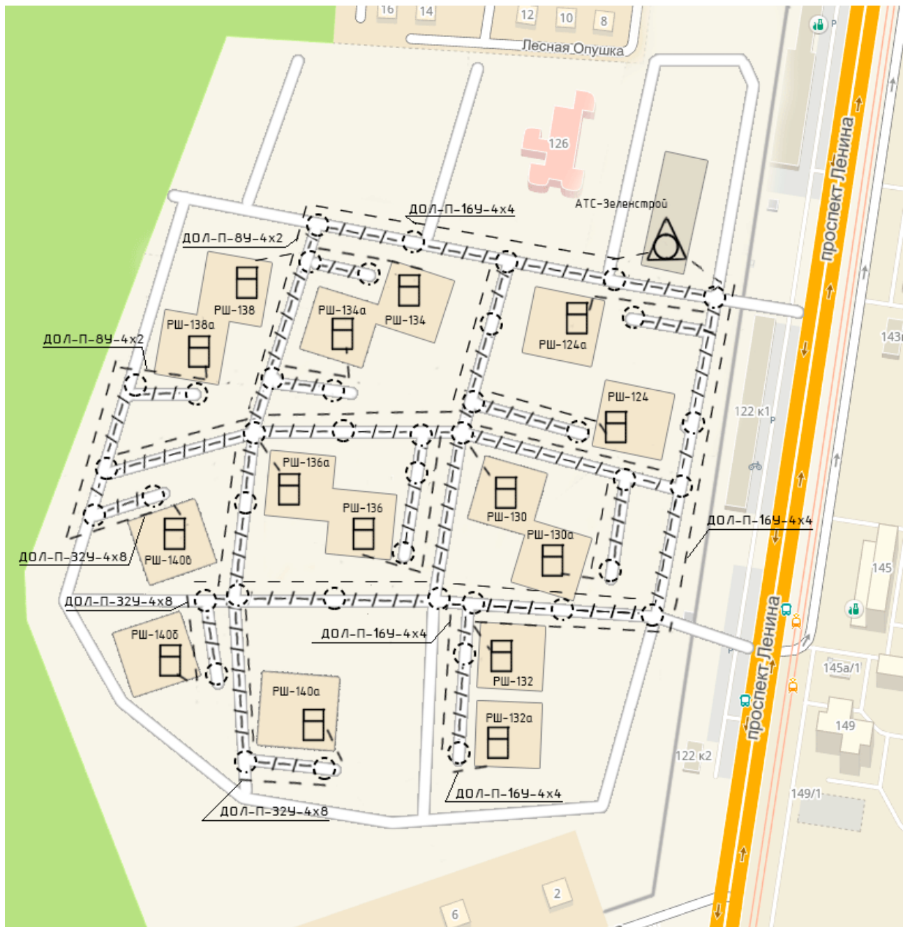
Рисунок 3.7 – Схема проектируемых линейно-кабельных сооружений ЖК “Зеленстрой”
