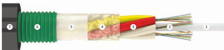
Рисунок 3.3– Конструкция кабеля ДОЛ [26]
