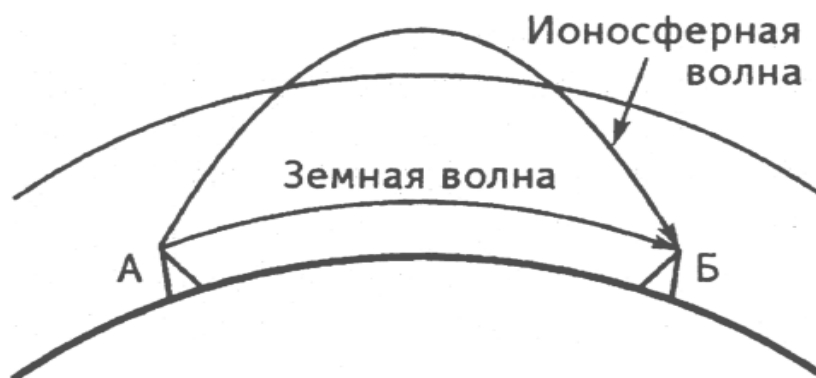
Рисунок 1.3 – Уменьшение амплитуды сигнала в точке приёма
