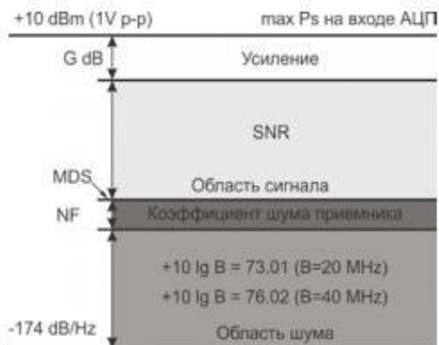
Рисунок 3.2 - Диаграмма уровней мощности в приёмнике
