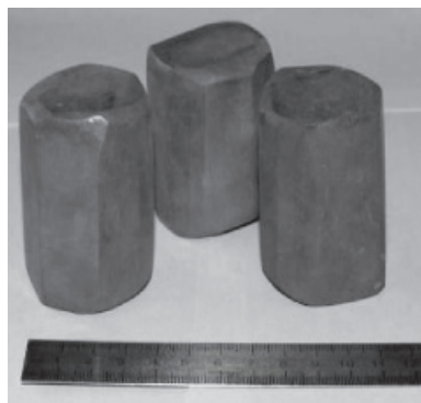
Рис. 1. Внешний вид образцов сплава ВТ6 после многократной всесторонней деформации в изотермических условиях
