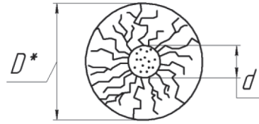
Рис. 4. Зона предразрушения от одиночного импульса. D^* \geq (3 \div 7)d в зависимости от свойств породы дна забоя
