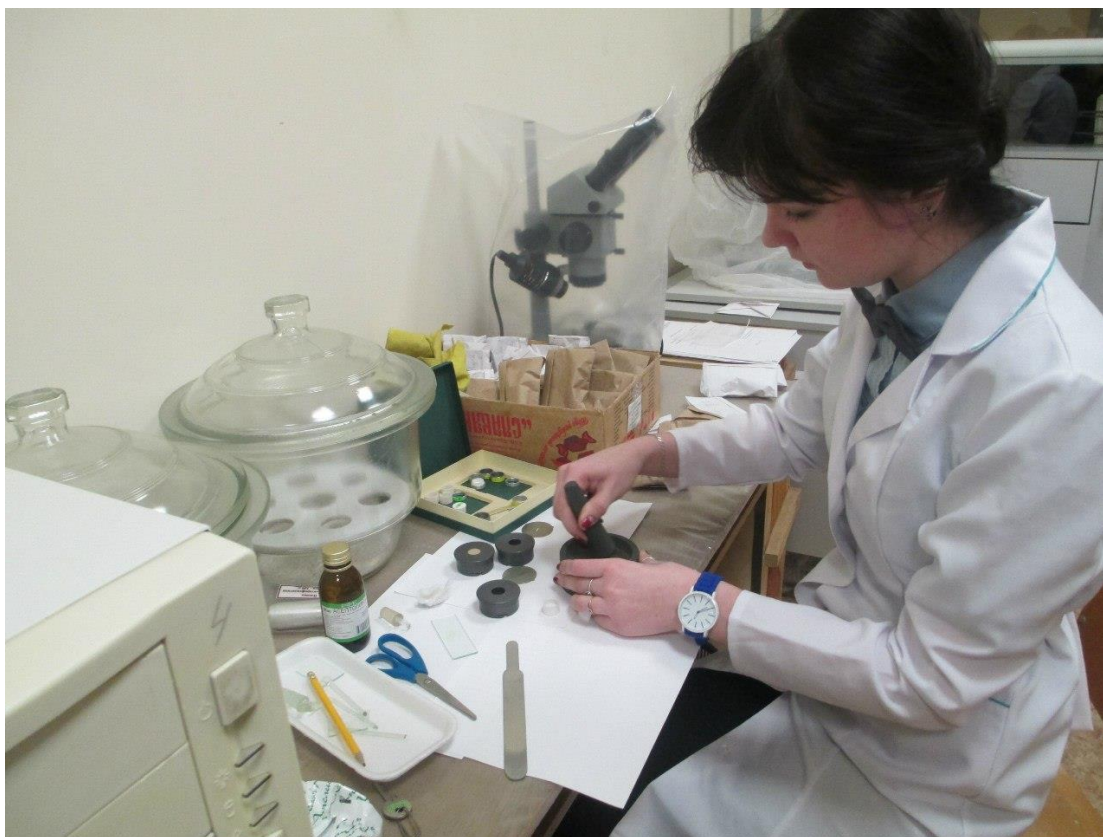
Рис. 2.4. Измельчение образца до состояния пудры (Фото Гаджикеримовой А.Г.)
